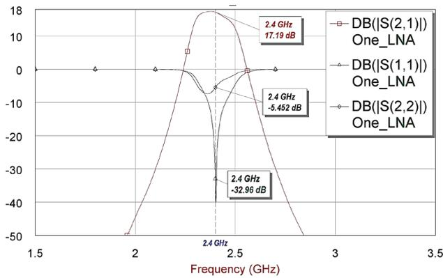
Figure 8. S parameters of one LNA.
