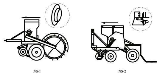
**Figure 1- Side views of no-till seeders and furrow openers (NS-1: Disc type, NS-2: Narrow hoe type)** *Şekil 1- Doğrudan ekim makinaları ve gömücü ayakların şematik görünüşleri (NS-1, Diskli tip; NS-2, dar çapa tip)*
